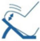
**1º** Presionar y soltar el pedal varias veces. Si hay aire en el sistema de frenos, con esta maniobra vuelve a funcionar.
